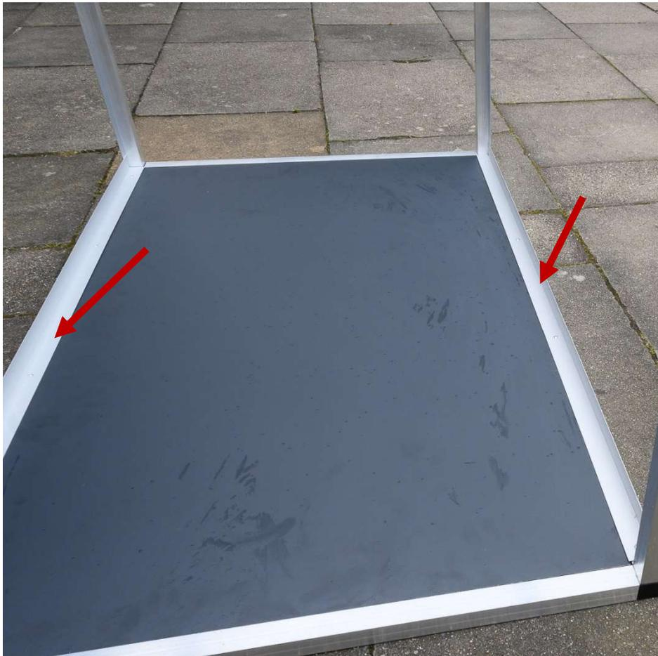
Die Seitenwände werden dann entsprechend festgenietet.
