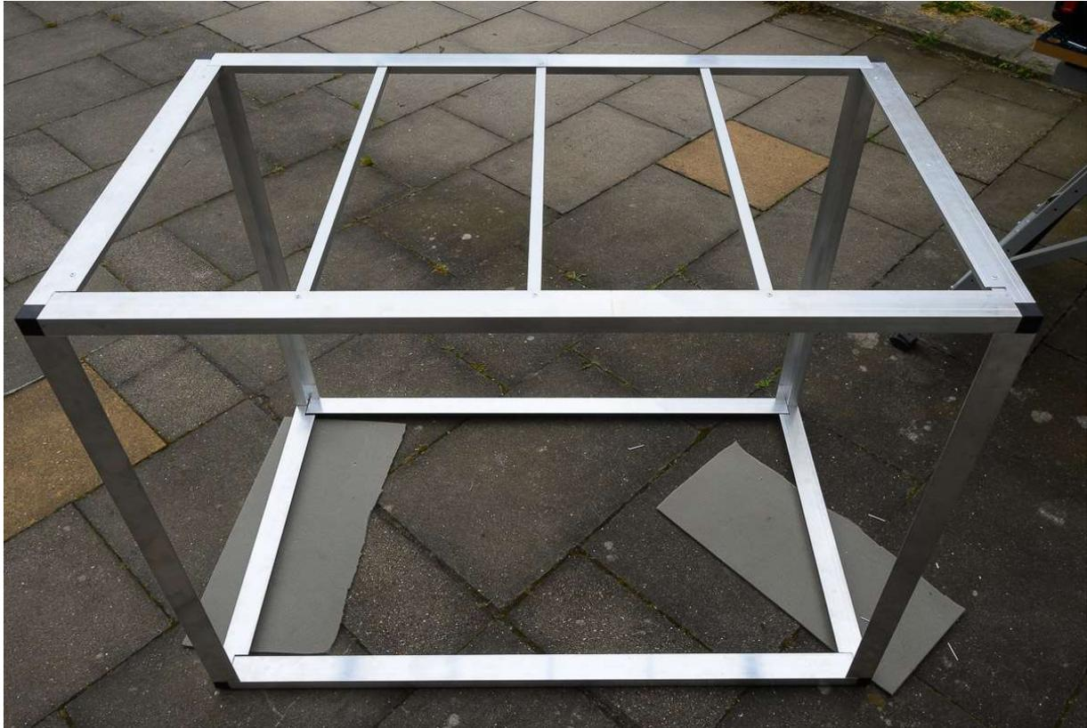
Der Ausgleich mit dem 15 mm Quadratrohr ist notwendig, damit die Bodenplatte ohne Übergang im Rahmen liegt.
