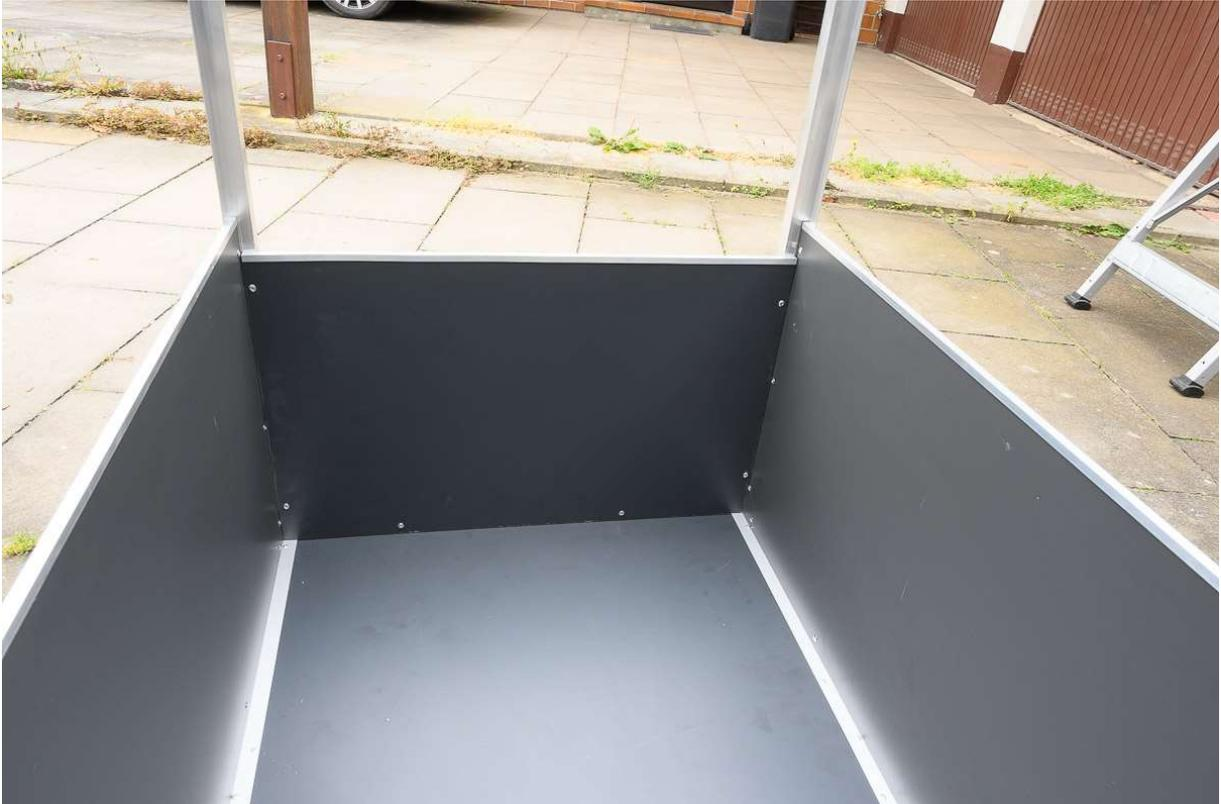
Damit sich die Rückwand nicht nach hinten durchbiegt wird diese noch mit einem Winkelprofil (20mm x 20mm) hinten fixiert.
