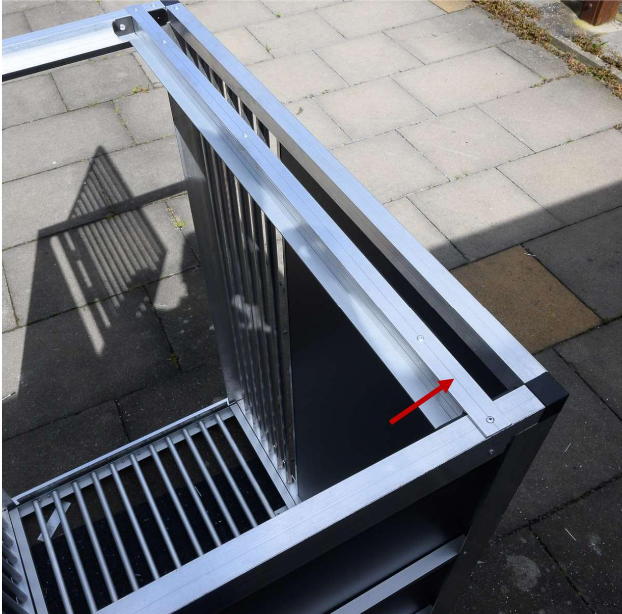
Damit die Tür nicht nach innen fallen kann wird am oberen Rahmen ein Winkelprofil mit 20mm x 20mm befestigt.
