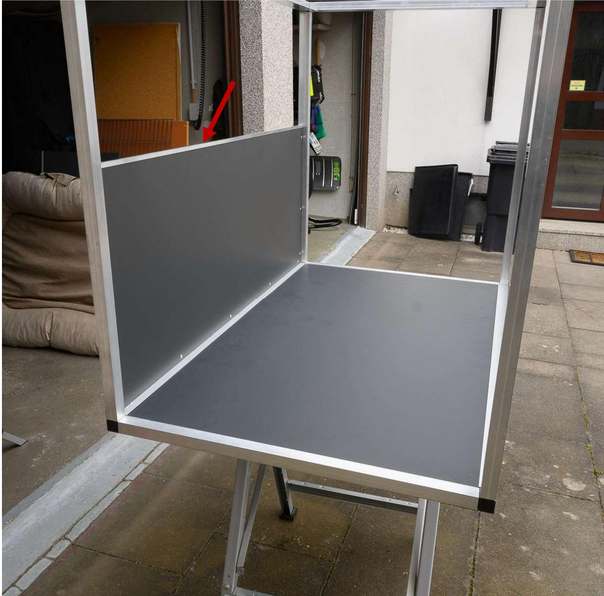
Zum Schutz wir die obere Kante der Platte mit einem U-Profil überdeckt.
