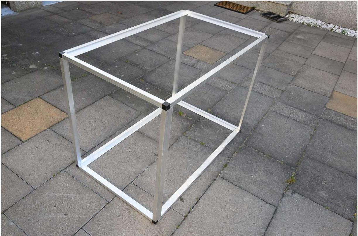
Die Profile werden so zusammengesteckt, dass später oben das Gitter eingelegt werden kann.
