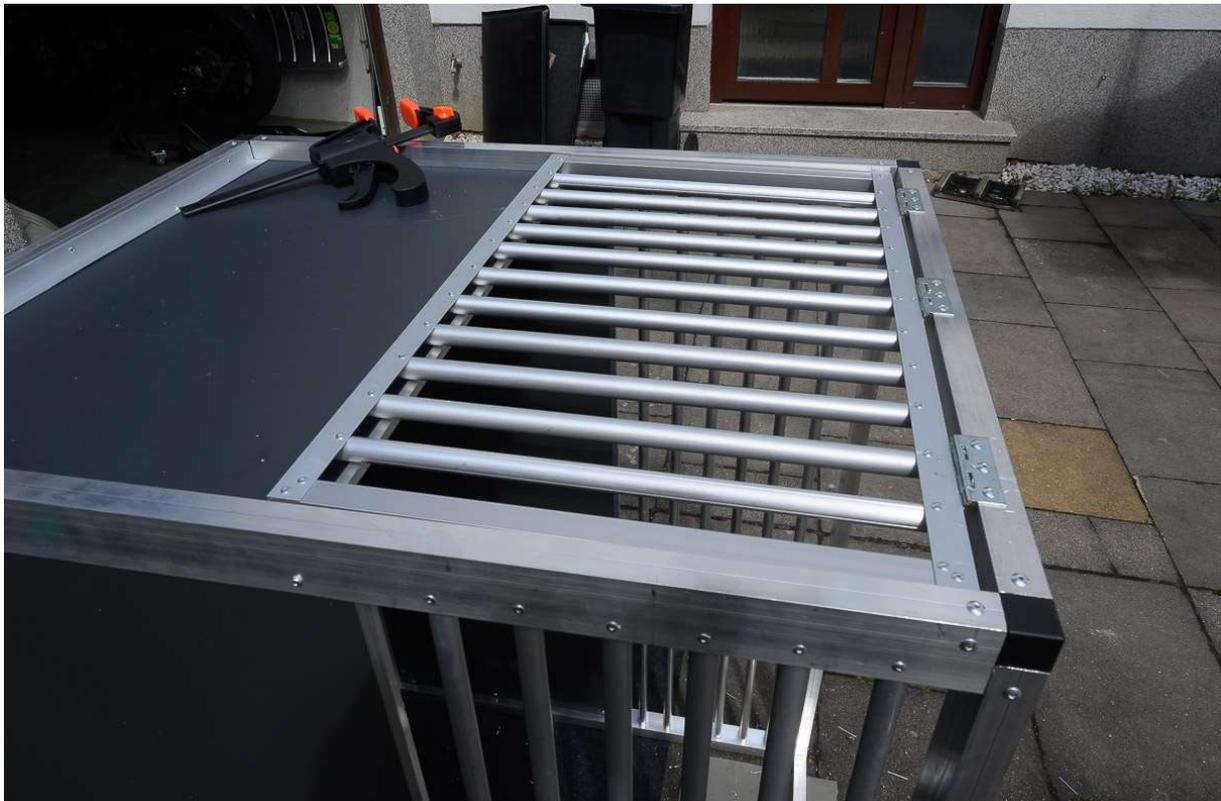
Damit es nicht klappert wird am unteren Ende ein Schaumstoffdichtung eingeklebt.
