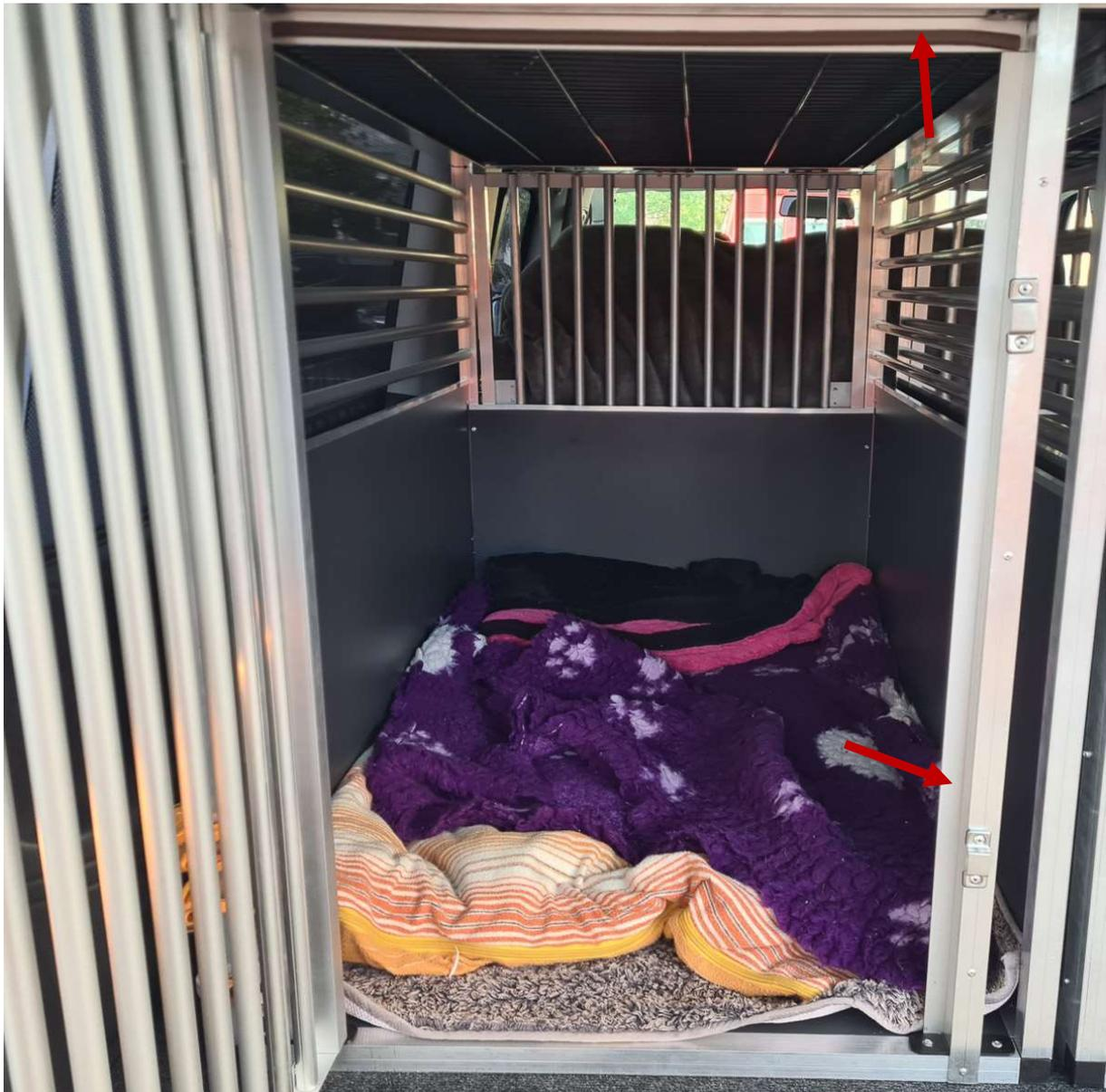
Damit die Tür nicht klappert ist am oberen Anschlag eine Schaumstoffdichtung angeklebt.
